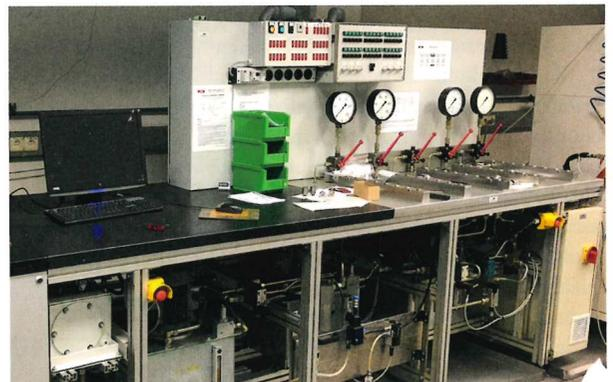
Den Druckschaltern sind hinsichtlich der Druckbelastung physikalische Grenzen gesetzt, das heißt wird die Druckbelastung zu groß, kann der Druckschalter beschädigt oder zerstört werden. Der Berstdruck definiert diese Grenze. Das Überschreiten dieser Grenze stellt ein erhebliches Sicherheitsrisiko für Mensch, Maschine und Umwelt dar.
