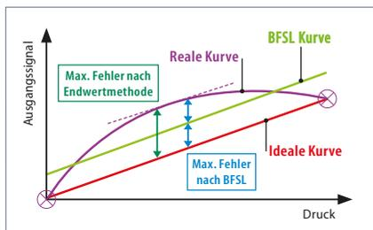
Als Referenzwert wird zudem in den technischen Spezifikationen die Nichtlinearität als BFSL (Best Fit Straight Line) ausgegeben. Die Nichtlinearität hat in der Regel den größten Gesamtfehleranteil. Typischerweise entspricht Nichtlinearität nach BFSL der Hälfte der Nichtlinearität nach Endpunktmethode ( $1\% \text{ FS} \sim 0,5\% \text{ BFSL}$ ).
